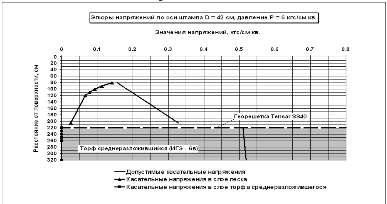
Рис. 10. Эпюры действующих и допускаемых активных касательных напряжений ( \tau_{акт} ) в слабосвязном слое дорожной одежды и подстилающем грунте
